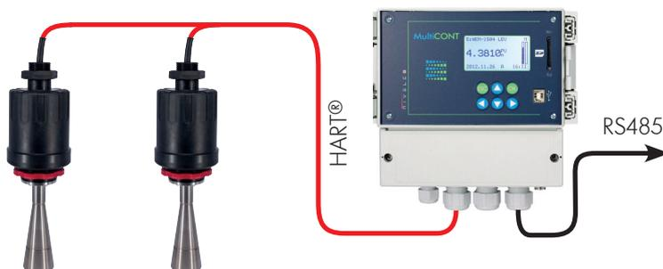
**MultiCONT** može obrađivati digitalne podatke koji dolaze od HART® kompatibilnih NIVELCO transmitera (npr. razina, temperatura, tlak, pH, otopljeni kisik itd.). Digitalna (HART®) informacija je, prema potrebi, obrađena, prikazana i odaslana putem komunikacije RS485 prema PC-u. Daljinsko upravljanje transmitera je, također, moguće. Vizualizacija na PC-u je omogućena pomoću **NIVISION** software-a za vizualizaciju procesa.
